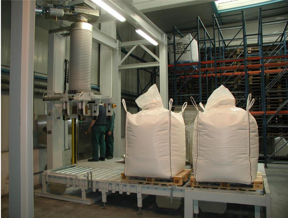
Die BITZER Big-Bag-Befüllstation ist zur automatischen Dosierung und eichfähigen Verwiegung nach dem Prinzip der Nettoverwiegung ausgelegt.
